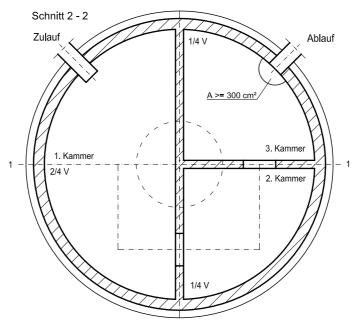
Beim Einbau ist die Einbauanleitung zu beachten! Anschluss des Zu- und Ablaufs mit KG-Rohr DN 160 Herstellen der Entlüftung des Zulaufs über das Dach.
